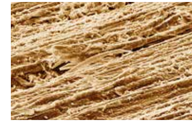
Alüminyum oksit ile zımparalama sonrasında ahşap yüzey.
