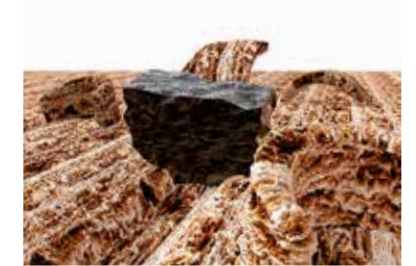
Silisyum karbür taneleri sert ahşabı keser.
