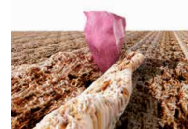
Alüminyum oksit taneleri yumuşak ahşabın içerisine nüfuz eder.
