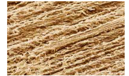
Silisyum karbür ile zımparalama sonrasında ahşap yüzey.
