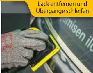
Lack entfernen und Übergänge schleifen
