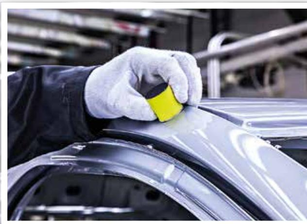
» Los discos de refinado resistentes al agua permiten obtener un corte rápido y un acabado fiable. Este producto se puede utilizar en húmedo o en seco con una lijadora orbital o una lijadora rotorbital.
