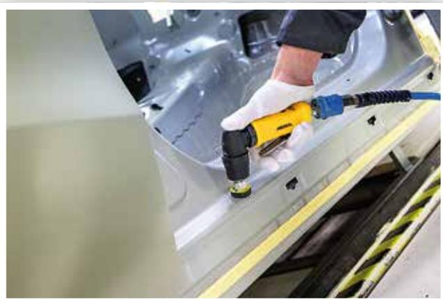
▶ Mirka® AOS 130NV con Polarstar P400. Lijado en zonas difíciles de alcanzar.
