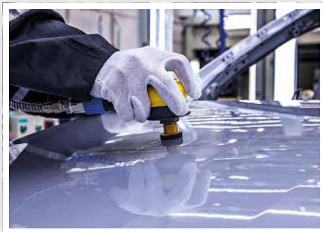
» Polarstar SR ofrece un acabado de alta calidad que facilita un rápido proceso de pulido. Mirka recomienda el lijado en húmedo con la lijadora orbital o rotorbital.
